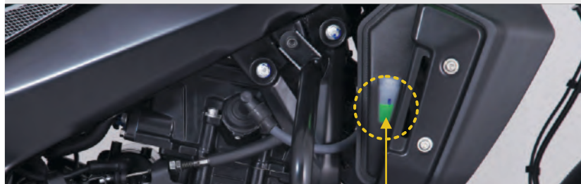
Depósito de expansão do líquido refrigerante
